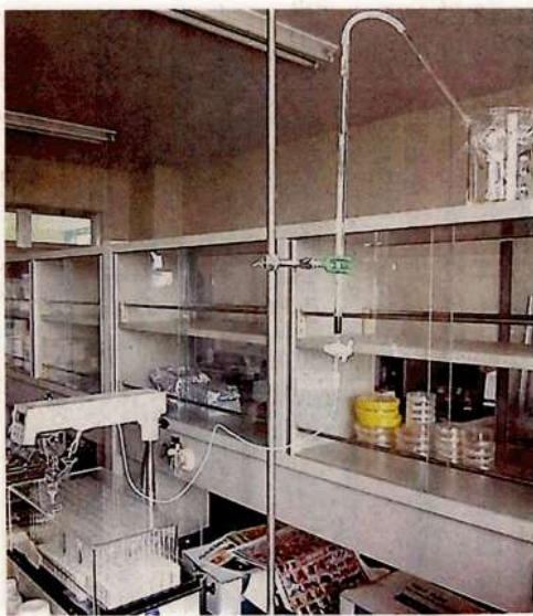
カラム法で金属イオンを除去する装置
